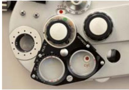
Abbildung 2: Visutest Phoroopter mit Astimess-Kreuzzylinder nach J. Reiner. Links ein Modell der ersten Baureihe. Rechts eine Teilansicht des weit verbreiteten Visutest D. Dieser Phoroopter wurde zum Standard in vielen Augenkliniken. Der Astimess-Kreuzzylinder wurde an einem Hebel per Hand hin und her geschwenkt. Genial am Astimess-Kreuzzylinder waren der extrem schnelle Glaswechsel und die Tatsache, dass der Anwender stets wusste, in welche Richtung man die Achse anschließend verdrehen musste.
