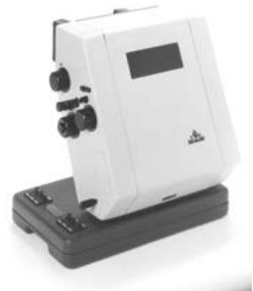
Abbildung 5: Mit dem „Mesotest“ und „Mesoptometer II“ konnte das Kontrastsehen bei Dämmerung geprüft werden.
