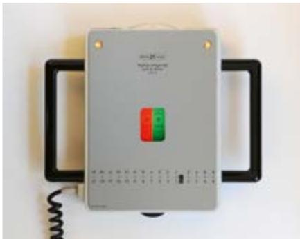
Abbildung 3: Das Nahprüfgerät nach Reiner enthielt eine von hinten beleuchtete, drehbare Scheibe, auf der zahlreiche Tests angebracht waren. Der Leseabstand konnte über zwei Lichtstrahlen, die auf die Stirn des Prüflings projiziert wurden, exakt eingestellt werden.
