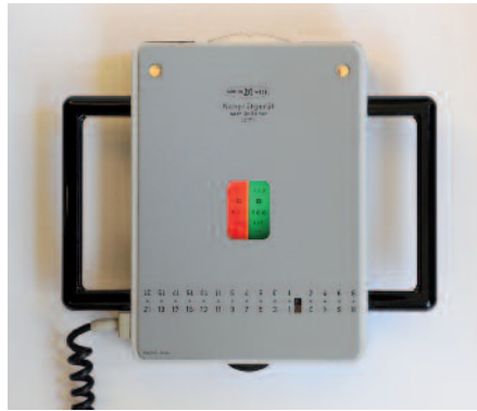
Abb. 5: Das Nahprüfgerät nach Reiner enthielt eine von hinten beleuchtete, drehbare Scheibe, auf der zahlreiche Tests angebracht waren. Der Leseabstand konnte über zwei Lichtstrahlen, die auf die Stirn des Prüflings projiziert wurden, genau kontrolliert werden.
