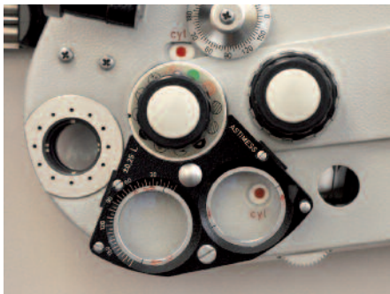
Abb. 3: Visutest Phoropter mit Astimess-Kreuzzylinder nach Reiner. Oben ein Modell der ersten Baureihe. Unten eine Teilansicht des weit verbreiteten Visutest D. Dieser Phoropter wurde zum Standard bei vielen Augenoptikern und in vielen deutschen Augenkliniken. Der Astimess-Kreuzzylinder wurde vor der Durchblicköffnung an einem Hebel per Hand hin und her geschwenkt. Das Geniale am Astimess-Kreuzzylinder war nicht allein der extrem schnelle Glaswechsel, sondern die Tatsache, dass man aus der Stellung der zwei Kreuzzylindergläser stets wusste, ob man sich in der ersten oder in der zweiten Wendelage befand und in welche Richtung man die Achse verdrehen musste.
