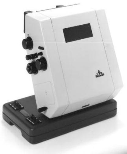
Abb. 8: Alle Personen, die beim Führerscheinsehtest durchfallen, müssen zur gutachterlichen Augenuntersuchung. Nach den Vorschriften der DOG muss dabei auch das Kontrastsehen bei Dämmerung geprüft werden. Die 1980 von Reiner entwickelten und von Oculus gebaute Geräte „Mesotest“ und „Mesoptometer II“ waren in Deutschland für viele Jahre der „Goldstandard“. (Foto: Oculus)
