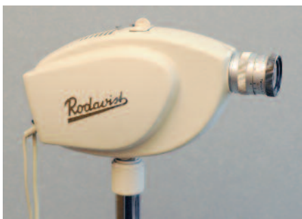
Abb. 4: Der Rodavist Sehzeichenprojektor zählte zu den ersten Geräten mit einer elektrischen Fernbedienung.
