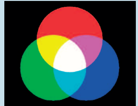
Abb. 7: Additive Farbmischung: Drei Projektoren projizieren in den drei Primärfarben. Wenn die Farben überlagert werden, ergeben sich Mischfarben. Bei einem ganz bestimmten Mischungsverhältnis erhält man als Mischfarbe „Weiß“. Wenn andere Primärfarben verwendet werden, ist auch das Mischungsverhältnis für „Weiß“ anders.
